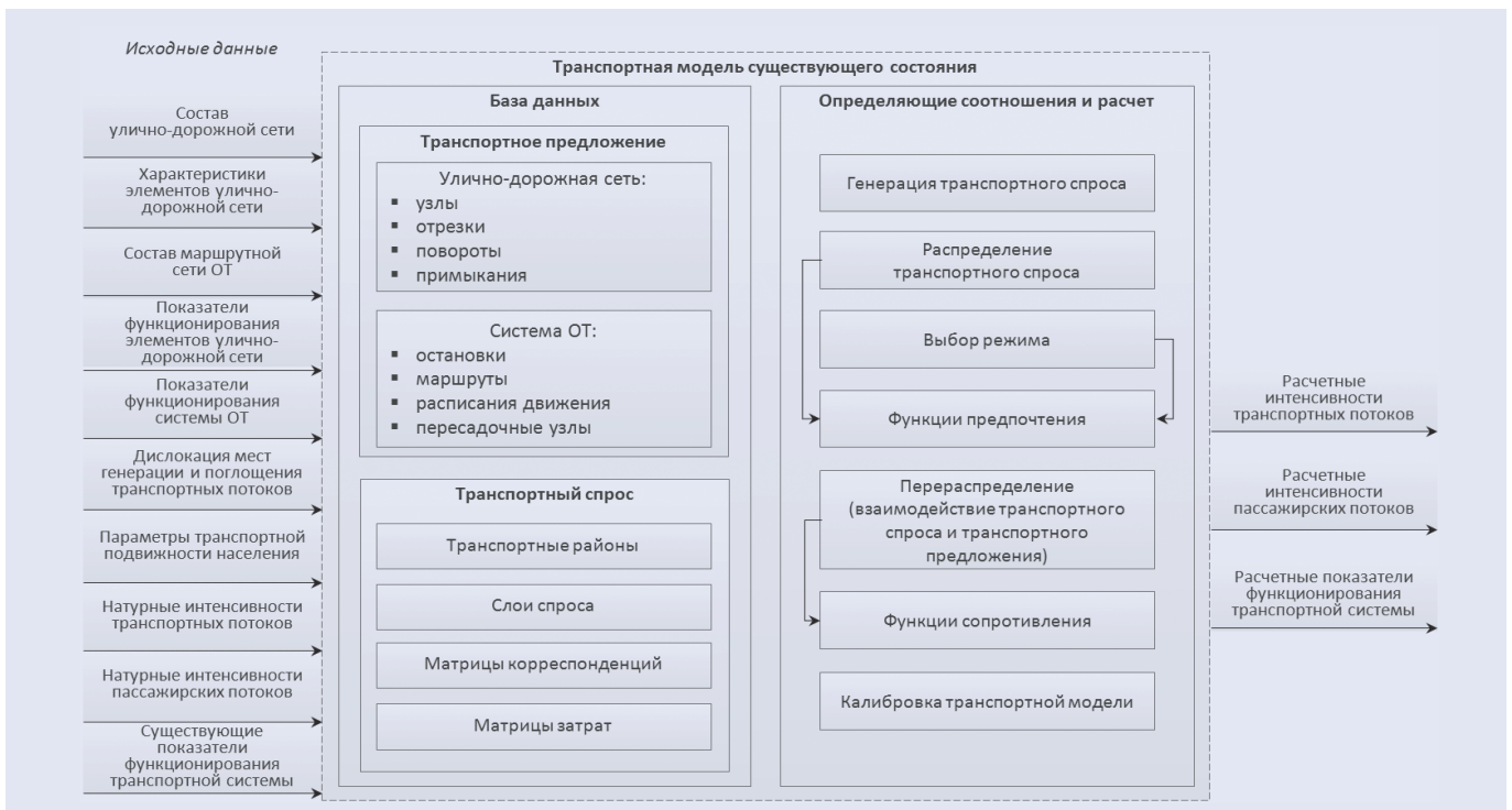
Рис. 2. Структура и состав прогнозной транспортной модели текущего состояния транспортной системы
