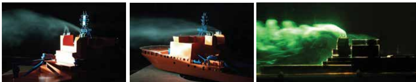
Рис. 5. Визуализация распространения дыма при \beta = 35^\circ (слева), \beta = 150^\circ (в центре), \beta = 0^\circ (справа) в аэродинамической трубе
