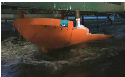
Рис. 13. Момент оголения днища носовой оконечности и соответствующая реализация ударного ускорения
