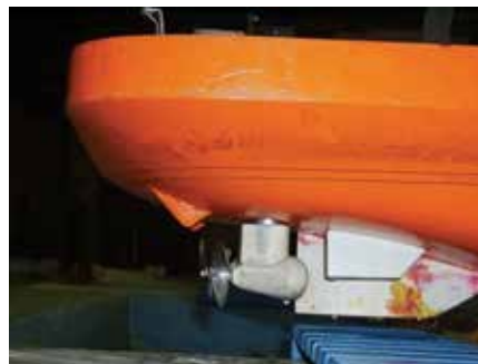
Рис. 6. Модель с увеличенным дейдвудом и шпорами до основной плоскости (слева) и стабилизаторами перед винто-рулевыми колонками (справа)
