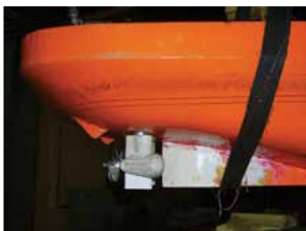
Рис. 6. Модель с увеличенным дейдвудом и шпорами до основной плоскости (слева) и стабилизаторами перед винто-рулевыми колонками (справа)
