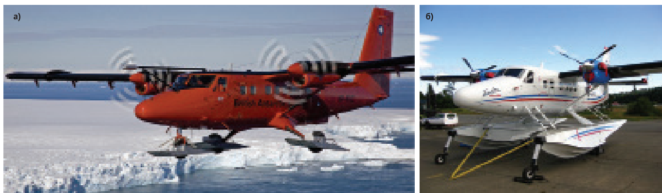
Рис. 5. DHC-6 Series 400 Twin Otter на колесно-лыжном (а) и амфибийном (б) шасси
