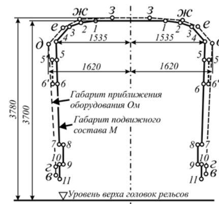
Рис. 1. Верхние очертания габарита приближения оборудования  $O_m$  и габарита подвижного состава  $M$
