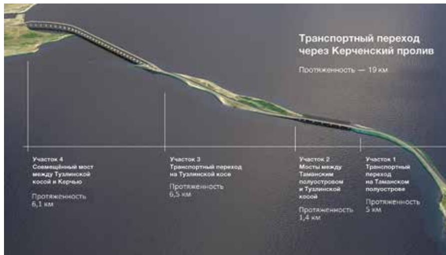
Рис. 5. Схема строительства транспортного перехода через Керченский пролив
