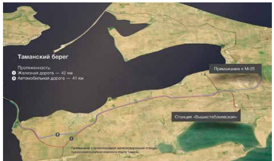
Рис. 6. Подходы к мостовому переходу со стороны Краснодарского края
